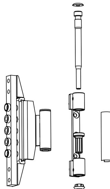
Système d'engondage à 1 axe
